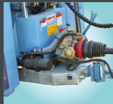
Pompa in ottone/scarico ecologico / Brass pump/Ecological discharge device (return on suction) / Pompe en laiton/Décharge écologique / Vorrichtung/Messingpumpe - ökologischer Abfluss / Bomba de membranas en latón/dispositivo de descarga ecológico
