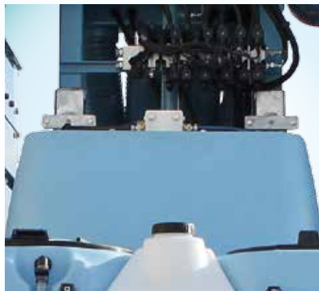
Venturimetro - Serbatoio integrato per la depressurizzazione del prodotto da recuperare in cisterna. (BREVETTATO) / Venturi - Integrated tank for depressurization of the product to be recovered in the tank (PATENTED) / Venturimètre - Réservoir intégré pour la dépressurisation du produit récupéré dans la cuve (Breveté) / Venturi-Messer - integrierter Tank zur Druckverminderung des Produkts zum Aufruf im Haupttank (patentiert) / Venturi - Depósito integrado para la despresurización del producto que debe recuperarse en tanque. (PATENTADO)
