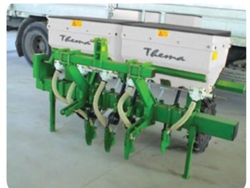
Versione con spandiconcime 220L e microgranulatore, ruote tractor e assolcatori concime
