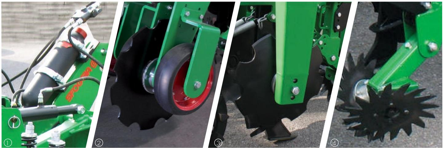
1. Cilindro ad azoto di carico elemento
