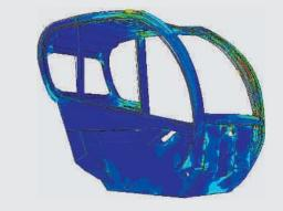
Cabina con **omologazione ROPS-FOPS** progettata con cellula di sicurezza per impedirne la deformazione in caso di ribaltamento o caduta di carichi pesanti.
