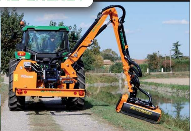
Le strutture realizzate in acciaio alto-resistenziale di prima qualità particolarmente elastico e gli elementi fondamentali delle articolazioni, boccole e spine, costruiti in acciaio sottoposto a trattamenti di durezza e rettifica, che ne aumentano la resistenza ed ne ottimizza la funzione allungandone la durata, i martinetti dotati di valvole di regolazione, garantiscono all'utilizzatore un braccio di notevole resistenza e ottima manovrabilità, fatto per durare nel tempo.
