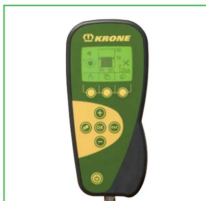
Terminale Beta ed elettronica Komfort: Comprende menu grafici con possibilità di richiamare le informazioni relative alla pressione di lavoro istantanea o il diametro istantaneo della palla, il numero di balle pressate, nonché verificare il funzionamento delle valvole e dei sensori.
