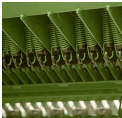
Massima sicurezza: la protezione dei coltelli con molle singole assicura l'elevata durata dei coltelli anche in caso di contatto con corpi estranei. Una volta passato il corpo estraneo i coltelli tornano automaticamente nella posizione iniziale.
