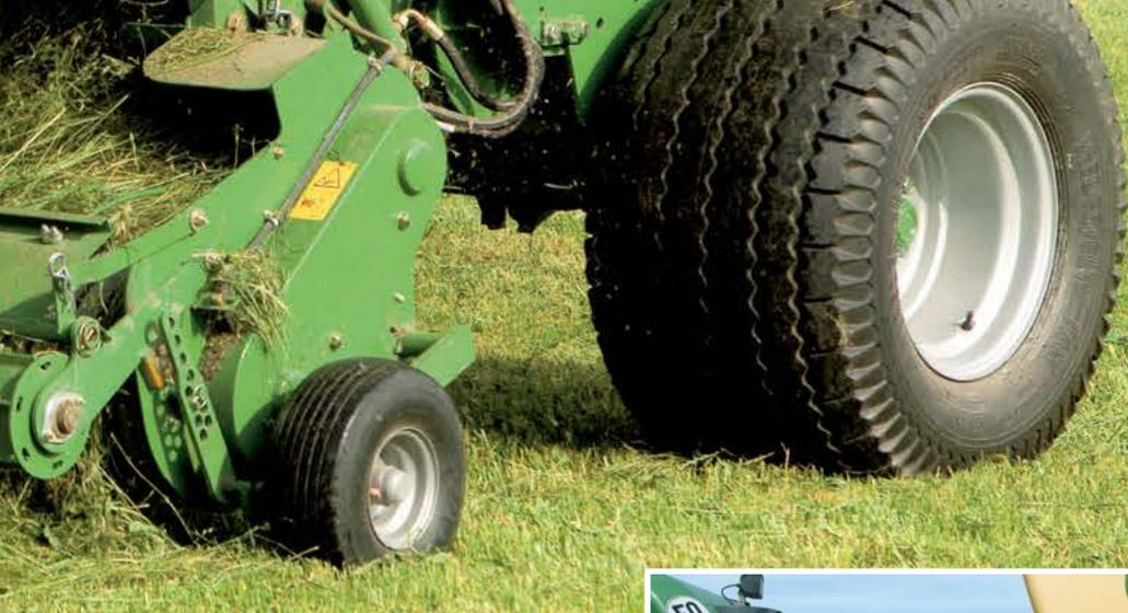
I vantaggi sono evidenti: il pick-up senza camme EasyFlow ha un principio costruttivo più semplice con molte meno parti mobili rispetto a un normale pick-up e sorprende per la regolarità di funzionamento. La minor usura derivante dalle caratteristiche costruttive si rispecchia in minori costi di manutenzione e riparazione. EasyFlow lavora ad un numero di giri superiore del 30% circa rispetto a modelli tradizionali, raccoglie di più e meglio.
