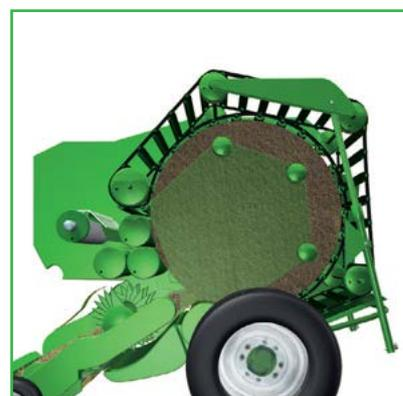
Funziona così: nella prima fase di formazione della palla le cinghie in tessuto gommato dell'elevatore a barre NovoGrip sono appoggiate ai rulli guida e formano una camera di pressatura poligonale.
