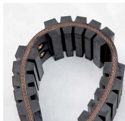
Cinghie in tessuto gommato a scorrimento continuo e barre in metallo: ideale per densità di compressione massime in paglia, fieno e insilato. L'elevata tensione delle cinghie garantisce la trasmissione sicura e l'accoppiamento dinamico della forza motrice.
