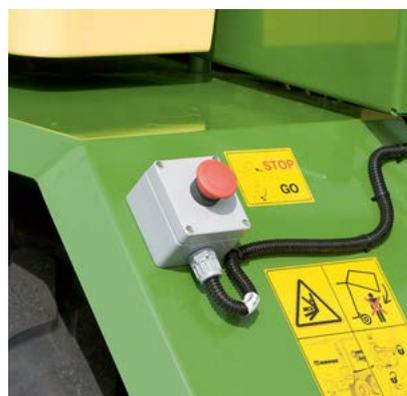
Sicuro: all'azionamento del pulsante di arresto rapido o dell'arco di sicurezza posto su entrambi i bracci del fasciatore tutte le funzioni del fasciatore vengono interrotte. Questo dispositivo assicura la massima sicurezza nel raggio di azione della macchina.
