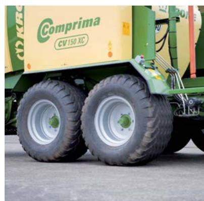
Assale tandem a portale KRONE non solo garantisce il trattamento delicato del suolo ma anche la marcia stabile e sicura. L'assale tandem può essere dotato di pneumatici con misure da 15.0/55-17 10 PR a 500/55-20 12 PR.
