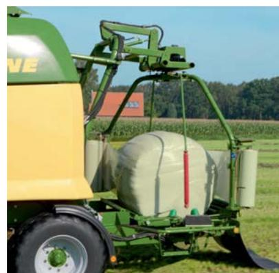
Fino a 1,75 m di diametro con balle di insilato: Comprima CV 210 XC permette di essere flessibili. Il sistema NovoGrip con incremento progressivo della pressione all'aumentare del diametro della palla assicura foraggio di qualità.
