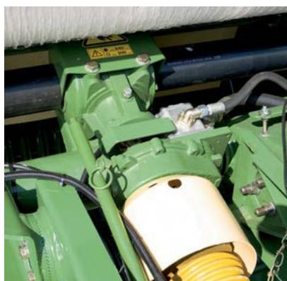
Trasmissioni separate: L'azionamento della pressa avviene mediante la trasmissione principale, il sistema idraulico di bordo viene azionato mediante un albero secondario e pompa idraulica. Le due trasmissioni possono essere disaccoppiate semplicemente. In caso di blocco della trasmissione principale il sistema idraulico di bordo può continuare a lavorare senza problemi.
