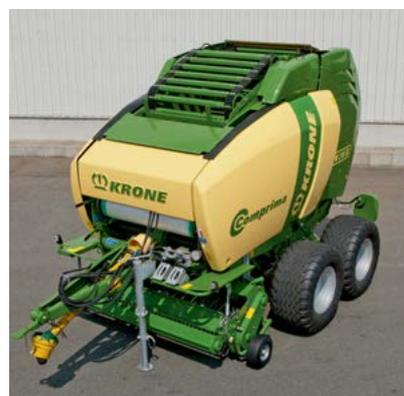
Design piacevole, caratteristica della gamma KRONE: I rivestimenti esterni in materiale plastico sono stabili e hanno una elevata durata, resistono agli urti, ai raggi UV e alle intemperie e sono insensibili a temperature molto elevate o molto basse.
