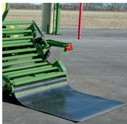
Scarico delicato: un tappeto in gomma protegge la palla da danneggiamenti durante lo scarico a terra. Quando non viene utilizzato il fasciatore, ad esempio con fieno e paglia il tappeto in gomma può essere sollevato e agganciato facilmente.
