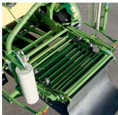
Più semplice non si può: il numero di strati di pellicola (2, 4, 6 oppure 8 strati) sono selezionabili direttamente dal posto di guida sul trattore mediante il terminale di comando. Un selettore posto sulla trasmissione permette di impostare il piatto del fasciatore per pellicola da 500 o 750 mm.
