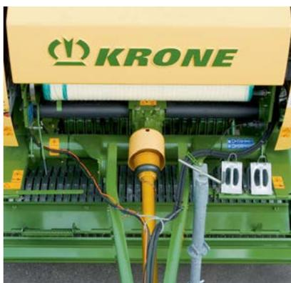
Piena potenza: la trasmissione principale (540 g/min) è in posizione centrale. Questo permette di avere su entrambi i lati alberi di trasmissione corti e una distribuzione ottimale della forza.
