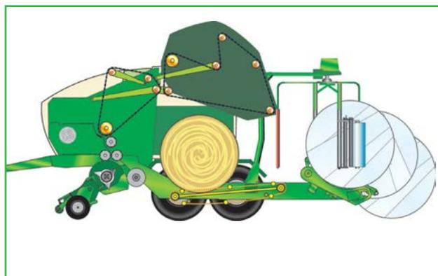
Tutto automatico: al riempimento della camera o al raggiungimento del diametro preimpostato l'operatore ottiene il segnale di fermarsi, la rete viene introdotta e la palla viene legata. Successivamente il portellone posteriore della pressa si apre e la palla viene spinta sul piatto del fasciatore. Mentre nella parte anteriore comincia la pressatura di una nuova palla, nella parte
