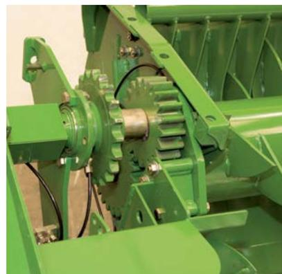
Efficiente: l'azionamento del rotore di taglio e introduzione avviene mediante ingranaggi sovradimensionati a denti dritti in grado di sopportare elevate sollecitazioni, è calettata e lavora in modo affidabile anche con andane irregolari.
