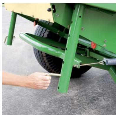
Diametro balle variabile da 1,25 a 1,50m a passi di 5 cm: i perni reversibili nelle leve di arresto telescopiche fungono da limitatori della corsa dei bracci tenditori e permettono pertanto di selezionare il diametro balla desiderato.
