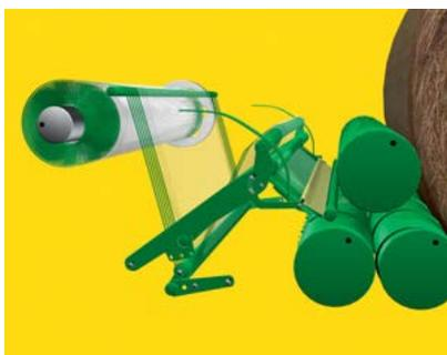
Posizione di introduzione: L'apposita forcella sposta la lamiera con la rete verso il rullo di introduzione. La rete viene catturata dal rullo di introduzione, portata nella camera di pressatura e infine tirata dalla palla. Il freno è disattivato. La lama di taglio è sollevata.
