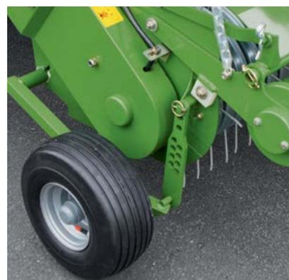
Trasmissione robusta: l'azionamento del pick-up avviene mediante una trasmissione a catena con tenditore automatico e dotata di frizione di sicurezza per la protezione da sovraccarichi e la massima sicurezza anche in caso di presenza di corpi estranei.
