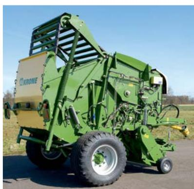
Geniale: Le leve di arresto telescopiche caricate da molle ai lati del portellone posteriore limitano la corsa dei bracci tenditori e quindi anche dell'elevatore. A fine corsa la camera di pressatura ha raggiunto il diametro stabilito.
