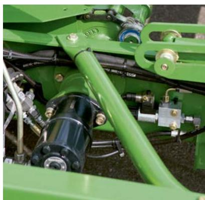
Potente: la catenaria del traslatore viene azionata su entrambi i lati mediante due motori idraulici. Indipendentemente dalla posizione della rotopressa combinata a fasciatore i due motori spingono in modo affidabile anche le balle più pesanti sul piatto del fasciatore.
