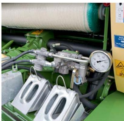
Per la vostra sicurezza: L'impianto frenante pneumatico è di serie su Comprima V 180 CX, CF 155 XC e CV 150 XC, sugli altri modelli è disponibile in opzione. I modelli destinati all'esportazione possono essere dotate a seconda del Paese di destinazione di impianto frenante specifico.
