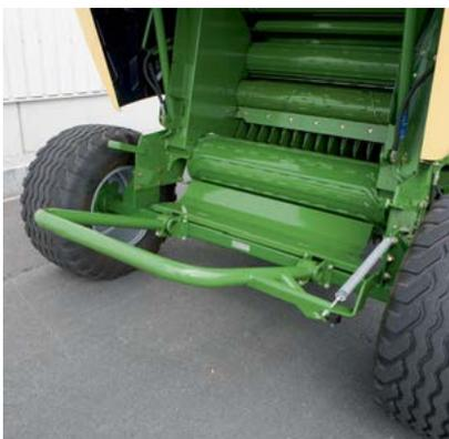
Espulsore balla disponibile in opzione: trasporta la balla fuori dal campo di azione del portellone posteriore. Una volta depositata la balla il portellone posteriore ha abbastanza spazio per chiudersi. Non è necessaria alcuna manovra dopo la legatura della balla.
