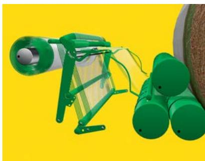
Posizione di taglio: La lamiera porta rete si solleva completamente. La lama di taglio viene rilasciata e colpisce la rete in tensione tagliandola di netto.
