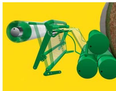
Posizione di legatura: La forcella riporta la lamiera in posizione di legatura. Il freno tende la rete. La palla tira la rete sopra all'allargatore e nella camera avviene la legatura.
