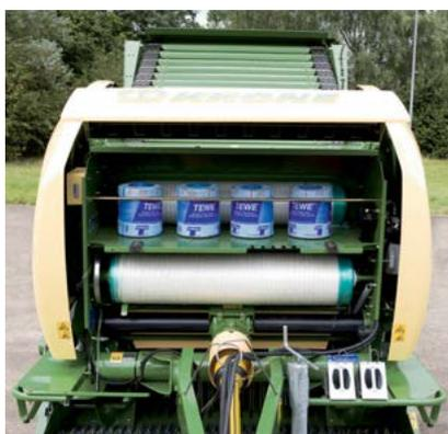
Ampia scorta: grazie al capiente vano impermeabile su Comprima c'è spazio per 10 bobine di spago, 4 bobine di spago e 2 di rete oppure 3 bobine di rete. Un supporto ne assicura il posizionamento sicuro.
