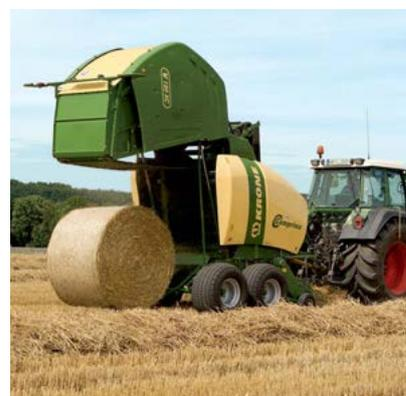
Comprima V 150, V 150 XC, V 180, V 180 XC, V 210 e V 210 XC rotopresse con camera variabile per balle con diametro da 1,00 a 2,05 m: KRONE NovoGrip con due elevatori a barre guidati da una doppia forcella è sinonimo di massima densità di pressatura.
