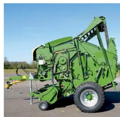
Semplice e ottima: Comprima F 155 con camera semivariabile convince per il suo principio costruttivo. In confronto a una rotopressa con camera variabile F 155 è composta da un numero minore di parti ed è costruita in modo comprensibile e compatto.
