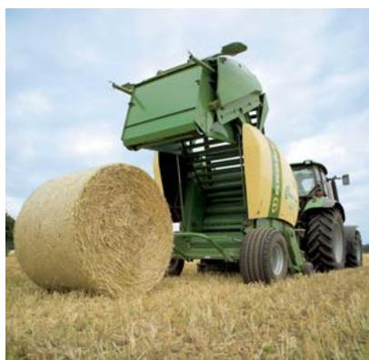
Comprima F 155, F 155 XC: Rotopressa a camera fissa con sistema semivariabile per balle con diametro da 1,25 a 1,50 m. La camera parzialmente variabile è unica ed è un'esclusiva KRONE.
