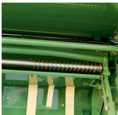
Sull'intera larghezza: il braccio e il rullo allargatori garantiscono la legatura omogenea sull'intera larghezza fino ai bordi della balla e, con rete Round Edge, anche oltre il bordo. Viene evitata la formazione di sacche d'aria ottenendo così insilato di ottima qualità in balle.
