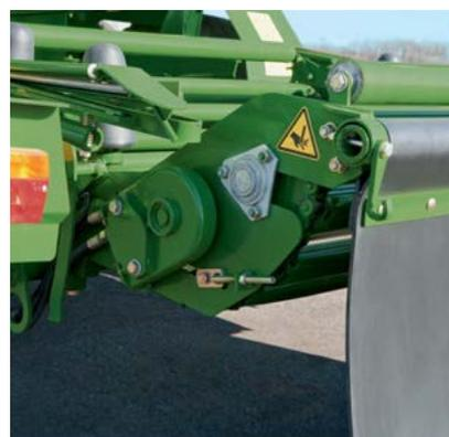
Doppio è più veloce: con due rotoli di pellicola il fasciatore con doppio braccio lavora ancora più velocemente. I ridotti tempi necessari per la fasciatura incrementano le prestazioni della macchina. Appositi sensori controllano la posizione dei bracci del fasciatore. Il riconoscimento automatico dello strappo pellicola avviene mediante sensori senza contatto.
