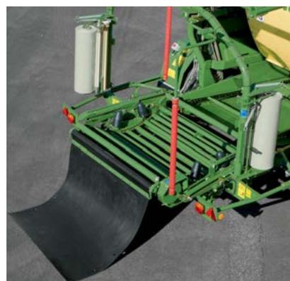
Rotazione sicura: L'elevatore a catenaria con barre del piatto del fasciatore assicura la rotazione di ogni balla. La guida impedisce l'oscillazione della balla sul piatto del fasciatore. La fasciatura avviene senza problemi.
