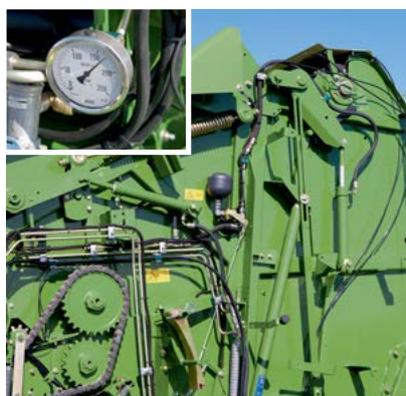
Densità di compressione regolabile mediante valvola di regolazione della pressione: Con l'aumentare della dimensione della balla e variazione della cinematica dei cilindri idraulici aumenta la pressione sulla balla stessa. In questo modo è assicurata l'elevata densità negli strati superiori anche per le balle di grandi dimensioni.
