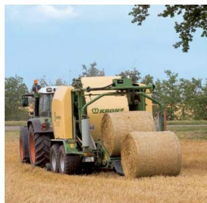
Ottimo: Comprima CF 155 XC, CV 150 XC e CV 210 XC sono estremamente versatili. Naturalmente su fieno e paglia è possibile lavorare anche escludendo il fasciatore. In tal caso le balle vengono "immagazzinate" e lo scarico avviene a coppie. L'operazione di recupero delle balle avviene più velocemente.
