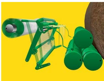
Posizione di partenza del legatore: durante l'operazione di pressatura la lamiera porta rete è sollevata. La rete viene tenuta dai denti della lamiera e sporge di circa 20 cm. Il coltello è ancora in posizione di taglio. Il freno rete è attivato.
