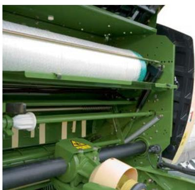
Elettrico: il legatore a rete viene avviato da un motore elettrico alla conclusione dell'operazione di pressatura. Il motore aziona mediante una forcella la lamiera di supporto che trasporta la rete direttamente alla camera di pressatura.
