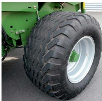
Assale e pneumatici: a seconda del modello e assale le rotopresse possono essere dotate di pneumatici con misure da 15.0/55-17 10 PR a 500/55-20 12 PR. Pneumatici più larghi sono più delicati sul terreno e provocano meno solchi.
