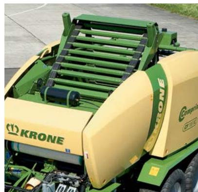
Il sistema NovoGrip con cinghie in tessuto gommato ed elevatore a barre fa parte della dotazione di tutte le rotopresse con fasciatore della serie Comprima: Il sistema NovoGrip unico nel suo genere, è sinonimo di elevata densità di compressione, funzionamento regolare ed elevata durata.
