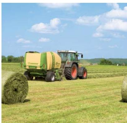
Comprima F 125, F 125 XC: Rotopressa a camera fissa per balle con diametro di 1,25 metri. La macchina convince grazie alla costruzione semplice. La misura delle balle rende questo modello particolarmente indicato per pressare insilato.
