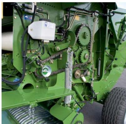
Durata incrementata: la lubrificazione centralizzata delle catene con capiente serbatoio e pompa a rotore eccentrico semplifica le operazioni di manutenzione e rende Comprima ancora più efficiente.
