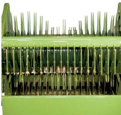
X-Cut 17: con il rotore di taglio, il massimo dei coltelli (17) e la minima distanza tra gli stessi (64 mm) si ottengono balle facilmente sfaldabili. I coltelli sono disposti in una fila per una qualità di taglio ottimale.
