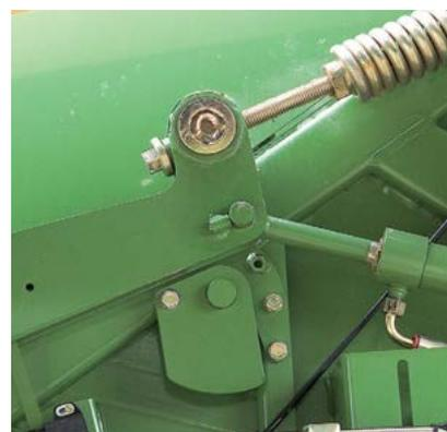
Sistema per nucleo tenero di serie: nella produzione di balle di fieno è spesso richiesto un nucleo più tenero, che consente una miglior evaporazione dell'umidità. Con la regolazione del diametro della camera nella fase iniziale è possibile influenzare la "morbidezza" del nucleo della balla.
