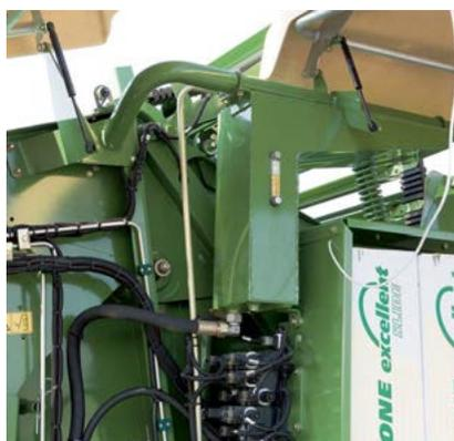
Sistema idraulico di bordo con serbatoio olio indipendente: assicura l'alimentazione del sistema idraulico indipendentemente dal trattore e l'azionamento omogeneo e costante di tutti gli aggregati idraulici. Il livello dell'olio è facilmente verificabile in ogni momento grazie al vetro spia posto sul serbatoio.
