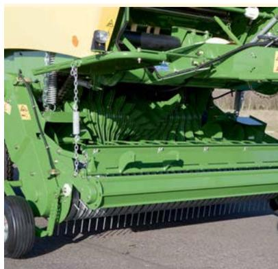
Rotore di taglio XC: poiché le rotopresse combinate a fasciatore vengono impiegate principalmente per la produzione di insilato, questi modelli sono dotati di serie di rotore di taglio con 17 coltelli o, in opzione, 26 coltelli con protezione delle singole lame.
