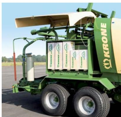
Vano per scorta pellicola: due ampi vani permettono di immagazzinare complessivamente 10 rotoli di pellicola (500 mm o 750 mm). I vani sono posizionati nelle vicinanze del fasciatore e proteggono la pellicola da umidità e polvere. Comprima CV 210 XC ha spazio per 12 bobine di pellicola.
